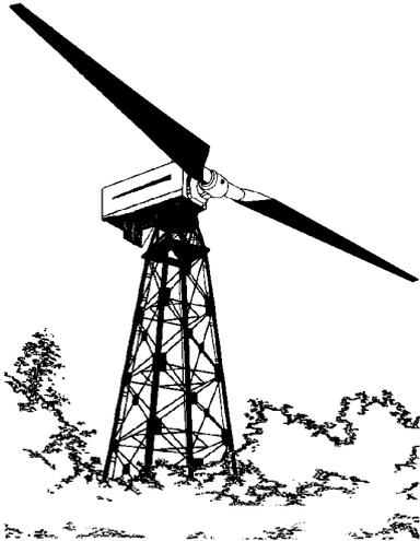
Fig V.7.- Aerogenerador experimental MOD-0A de 200 kW
