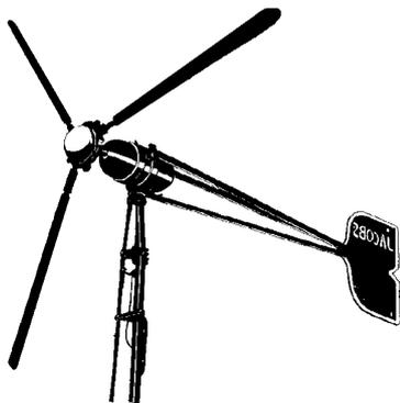
Fig V.1.- Aerogenerador Jacobs de 1 kW
