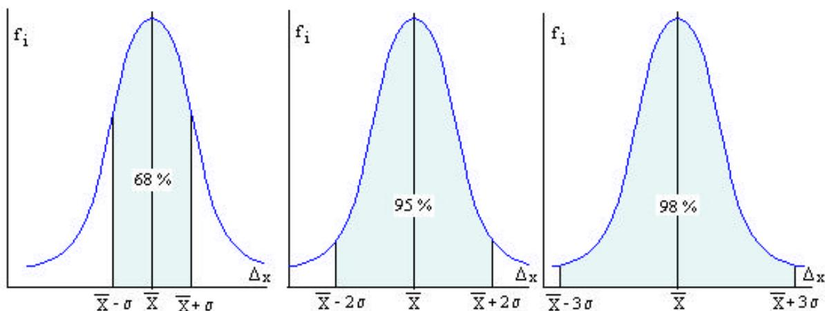
El **error más probable**  $\mu$  es el valor que determina el intervalo  $(\bar{X} \pm \mu)$  al cual pertenece el 50 % de las mediciones. Se demuestra que  $\mu = 0,6456 \cdot \sigma = \frac{2}{3} \cdot \sigma$ .
