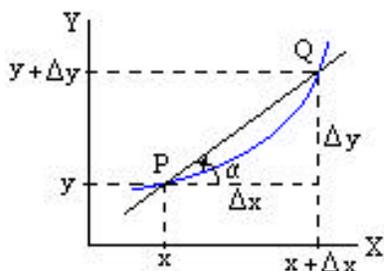
El incremento  $\Delta x$  puede considerarse como la apreciación de la medida x y el incremento  $\Delta y$  como la apreciación que le corresponde por medio de la función  $y = f(x)$ .
