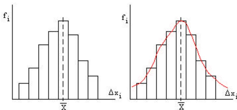
Si la amplitud de los intervalos de clase tiende a cero y el número de mediciones  $N$  tiende a infinito, el polígono de frecuencias se transforma en una curva. La experiencia muestra que, en todos los casos, el histograma que se obtiene puede ser aproximado por una función continua bien definida y única, cuya forma es siempre la misma, dependiendo sólo de dos parámetros  $\bar{X}$  y  $\sigma$ . Su ecuación es:
