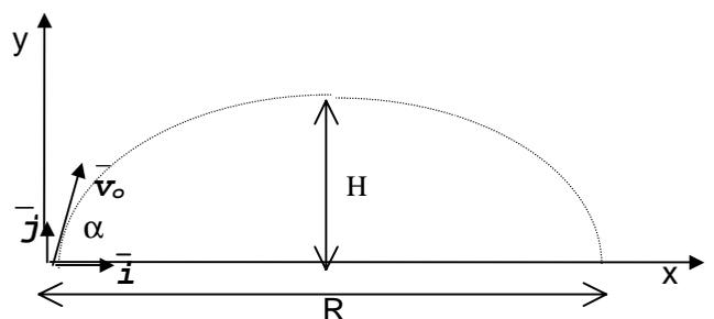
R es el alcance del tiro, se calcula reemplazando el tiempo total de vuelo del proyectil, en la ecuación horaria de  $x=f(t)$ , resultando:
