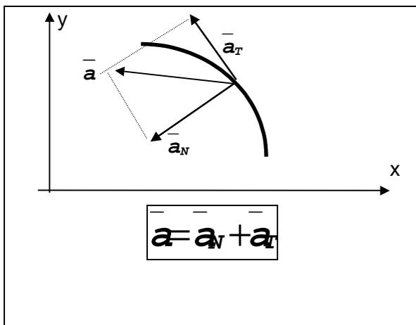
Cuando la trayectoria es curva, y el vector velocidad cambia de módulo, podemos descomponer la aceleración en un intervalo que tiende a cero, con una componente tangencial  $a_T$  en dirección a la recta tangente a la trayectoria y una componente normal  $a_N$  en la dirección perpendicular a la trayectoria que es responsable del cambio de dirección del vector velocidad.
