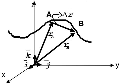
En la fig. se grafica el movimiento de un móvil que pasa, en un mismo intervalo de tiempo, por A y B siguiendo distintas trayectorias y que tienen la misma velocidad media.
