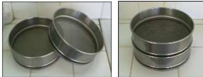
Tamices de 1 mm (parte superior) y 500 µm (parte inferior) de apertura de malla, para la separación de los macroinvertebrados (mayores de 0,5 mm).
