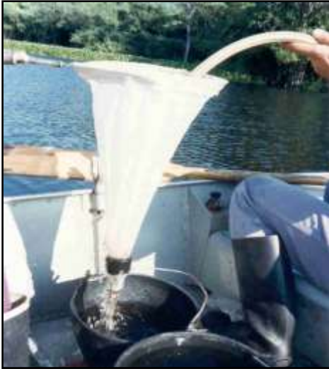
Toma del zooplancton con una bomba centrífuga y filtrado con red de 53 µm de abertura de malla.
