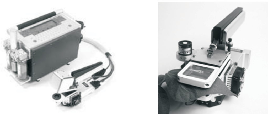
Fig. 3. Sistema para la medición del intercambio de gases fotosintéticos. Modelo LI-6400 (Tomado de www.licor.com ).
